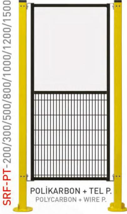
Çerçeve profili 20x20 kutu profilden, komple 4 mm kalınlığında kırılmaz polikarbon malzemeden oluşabildiği gibi isteğe bağlı olarak Panel aralıkları 20x100 veya 40x40 telden oluşmaktadır.
