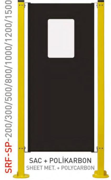
Çerçeve profili 20x20 kutu profilden, sst kısmı 2mm kalınlığında ST52 sac malzemeden oluşmaktadır, pencere ölçüleri ise isteğe bağlı üretilmektedir. Kapalı kaynak hücrelerinde ışık geçirmediğinden sıklıkla kullanılır.
