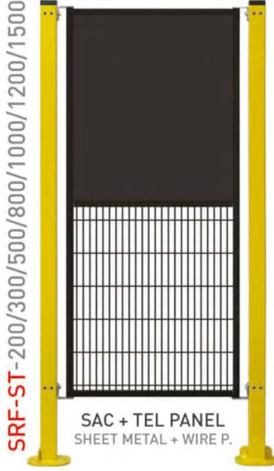
Çerçeve profili 20x20 kutu profilden, panel göz aralıkları tercihe bağlı olarak 20x100 veya 40x40 telden oluşmakta, üst kısmı 2mm kalınlığında ST52 sac malzemeden oluşmaktadır.
